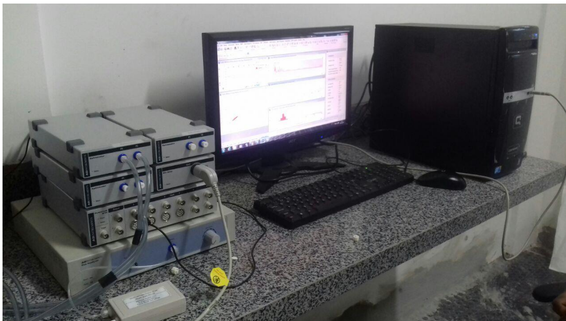
Figura 1 - Sistema de aquisição de dados monitoração multimodal de biosinais Powerlab PL3508 (AD Instrument - Australia) utilizados para realização do experimento no laboratório de fisiologia do Hospital Veterinário do IFPB - Campus Sousa. Fonte: Arquivo Pessoal.
