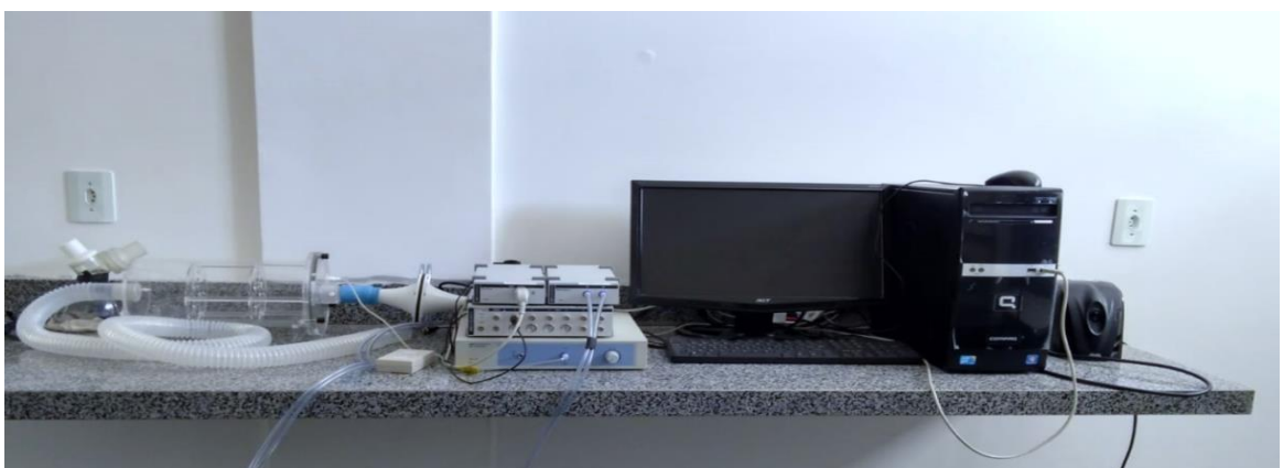
7 Figura 6- Sistema de aquisição de dados monitoração multimodal de biosinais Powerlab PL3508 (AD 8 Instrument - Australia) utilizados para realização do experimento no laboratório de fisiologia do Hospital 9 Veterinário do IFPB - campus Sousa
