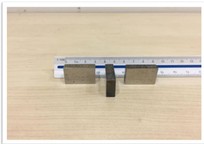
Figura 20 - Amostra de aço inoxidável duplex SAF 2205
