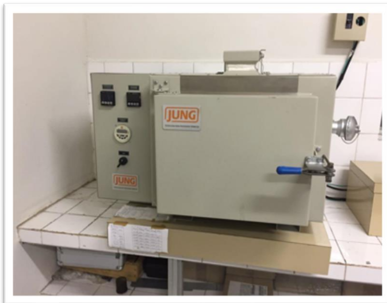
Figura 21 - Forno tipo mufla utilizado no envelhecimento das amostras
