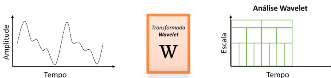
Figura 7 - Análise tempo-frequência de um sinal através da Transformada Wavelet
