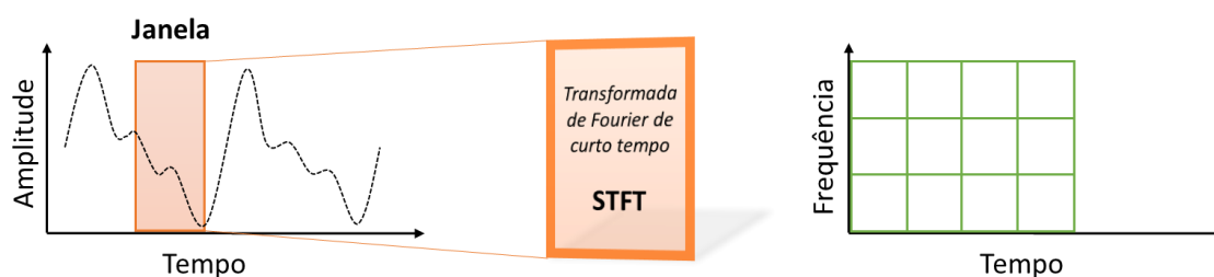
Figura 6 - Análise tempo-frequência de um sinal através da STFT
