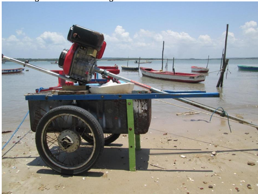
Figura 6 – Carro de geladeira com motor de rabeta.
