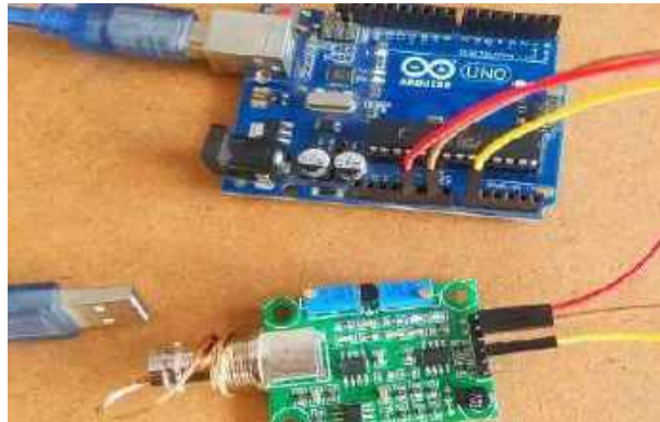
Figura 33. Obtenção do Offset do módulo da sonda.
