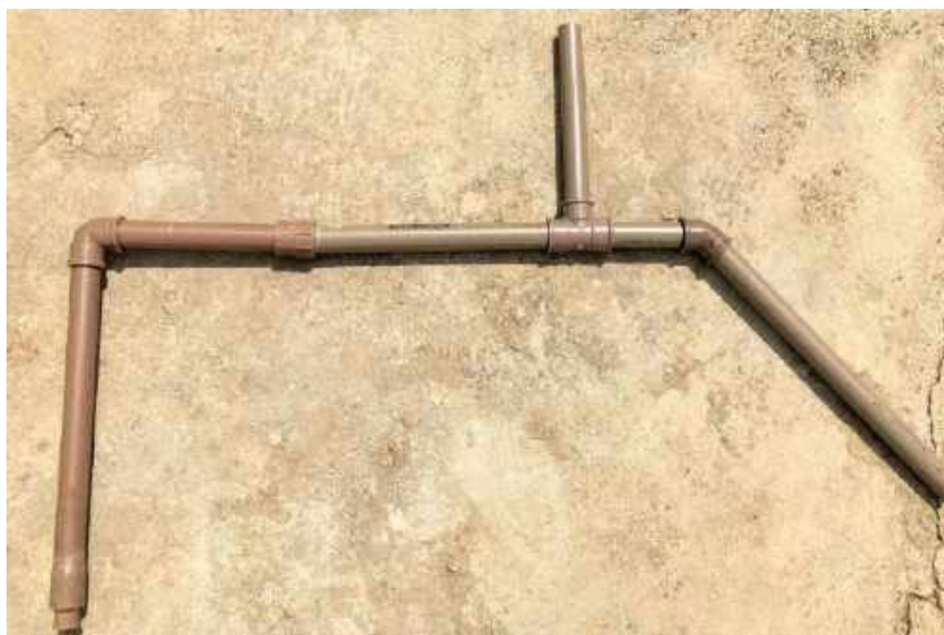
Figura 29. Tubo Venturi montado.
