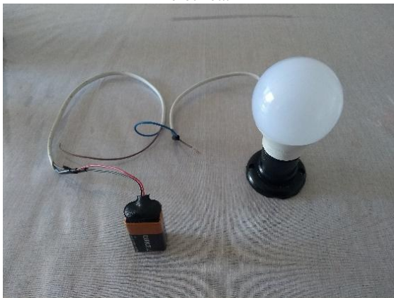
Figura 1: Dispositivo para teste de condutividade elétrica.
