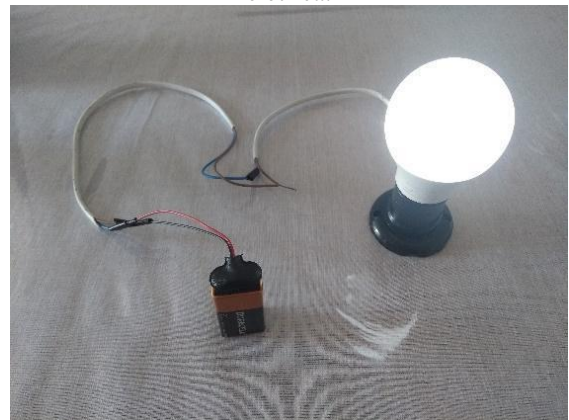
Figura 2: Dispositivo para teste de condutividade elétrica.
