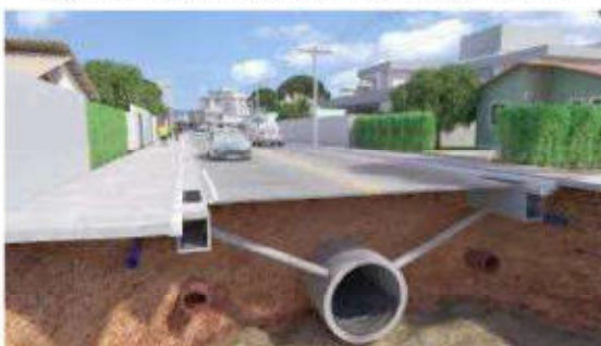
Figura 2 – Sistema tradicional de drenagem urbana
