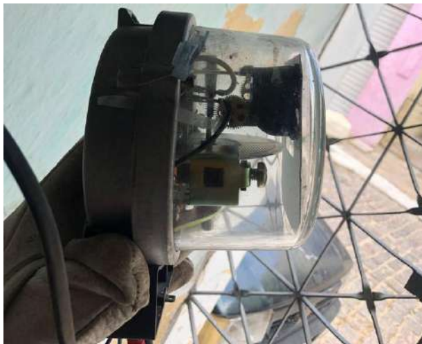
Figura 9 – Estrutura interna do medidor eletromecânico.
