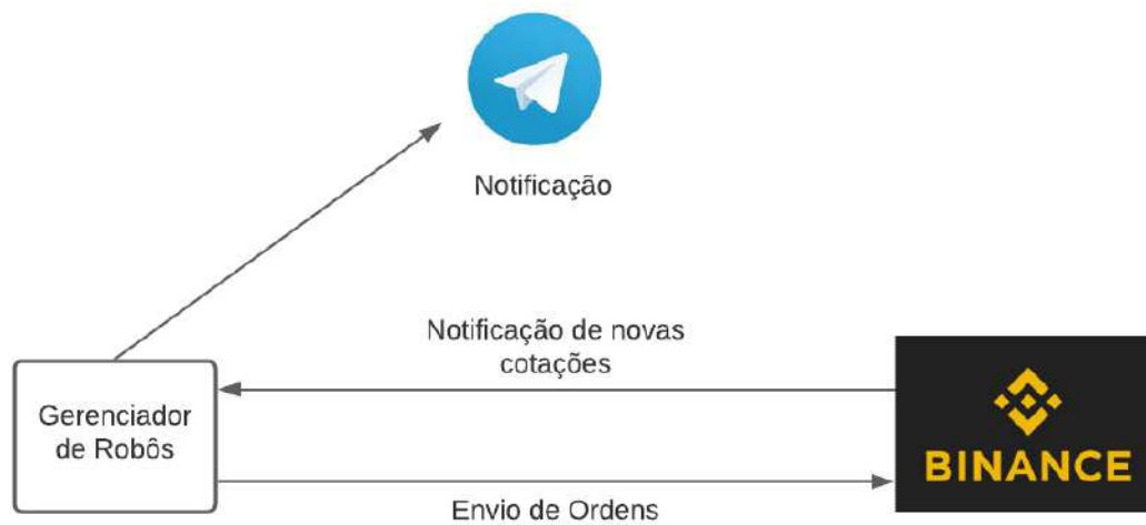
Figura 3.3: Estrutura do Worker de Execução de Robôs
