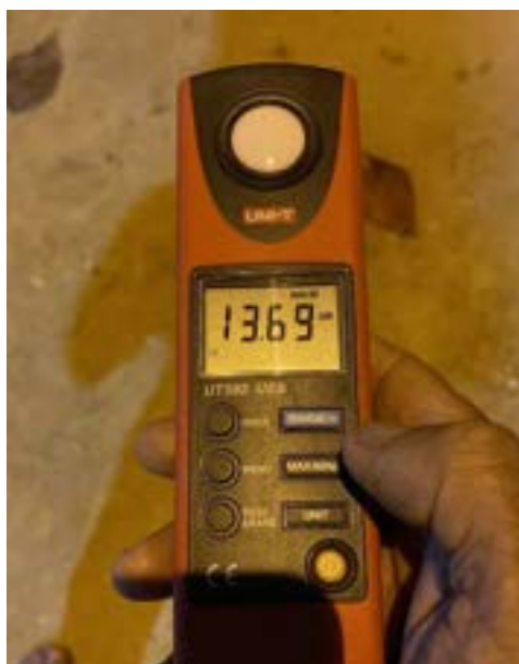
Figura 40 - Medição de iluminância lâmpada VS de 250W
