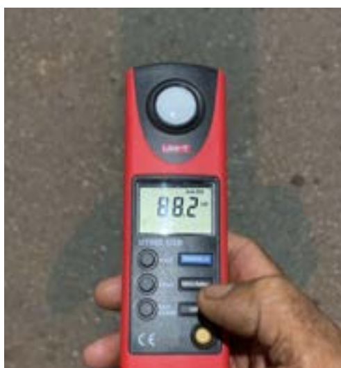
Figura 41 - Medição da iluminância lâmpada LED de 120W
