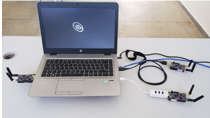
Figura 17 – Gateway utilizado no experimento, com três OpenMote-B e um laptop.
