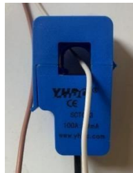
Figura 7 – Como usar o Sensor de Corrente SCT-013
