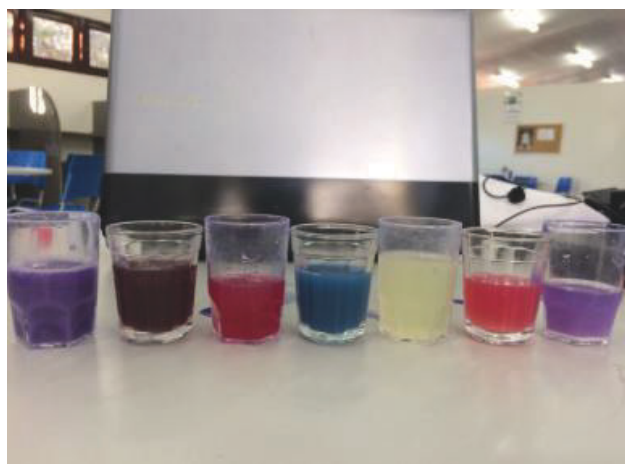
Figura 16: Soluções contendo extrato de repolho roxo funcionando como indicador de pH.
