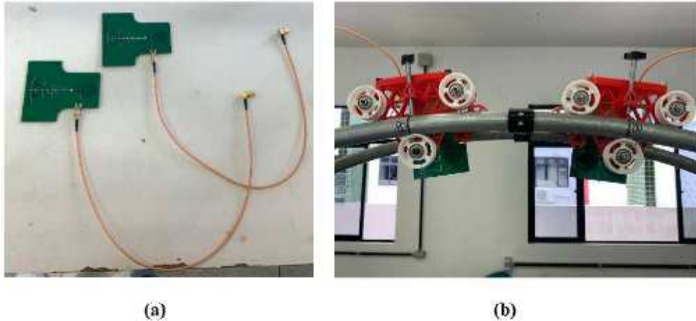
Figura 7 - (a) Antenas do tipo UWB (b) Estrutura impressa em PLA para suporte das antenas.
