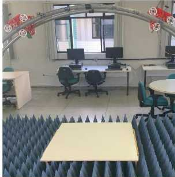
Figura 17 - Porcelanato 60\text{ cm} \times 60\text{ cm} posicionado no Arco NRL para as medições
