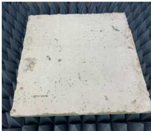
Figura 4 - Placa produzida de concreto 60 cm x 60 cm utilizada para realização das medições.
