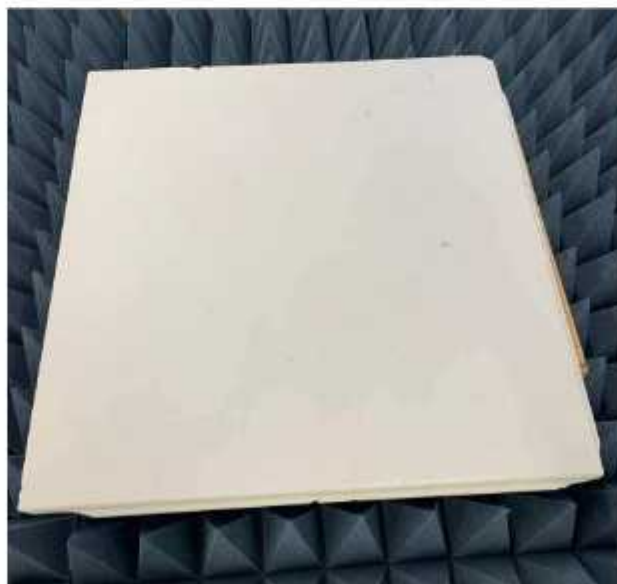
Figura 5 - Placa de gesso utilizada como MUT ( material under test ) nas medições.
