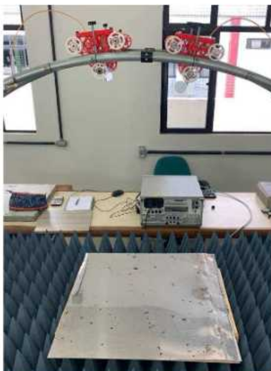
Figura 10 - Placa de alumínio 60 cm x 60 cm para a referência de reflexão total
