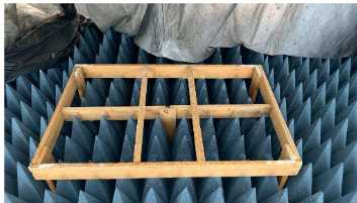
Figura 8 - Suporte confeccionado em madeira para apoio do MUT
