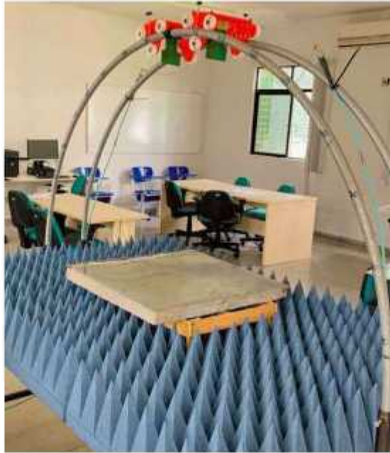
Figura 11 - Placa de alumínio 60 cm x 60 cm colocada sobre a amostra de concreto
