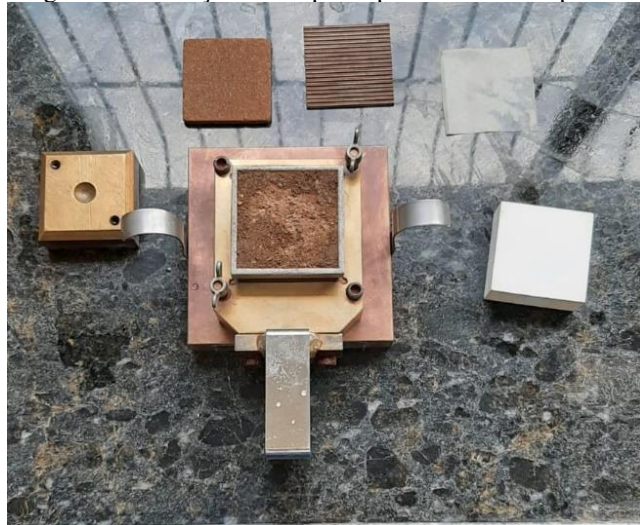
Figura 11 - Inserção do corpo de prova na caixa bipartida
