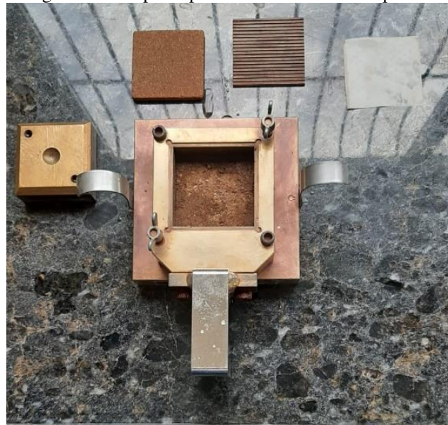
Figura 12 - Corpo de prova inserido na caixa bipartida
