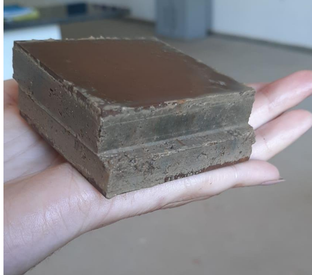
Figura 13 - Corpo de prova após o ensaio de cisalhamento direto
