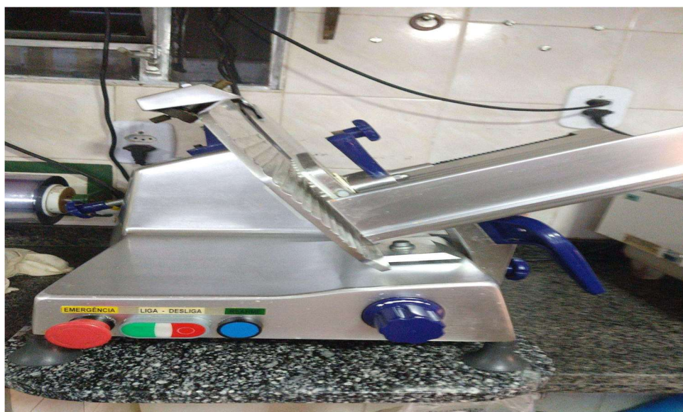
Figura 7 – Fatiadora em bancada desregulada e com fiação exposta
