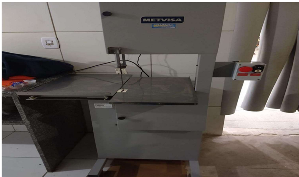
Figura 6 – Serra fita sem proteção e com ajuste de madeira nos pés
