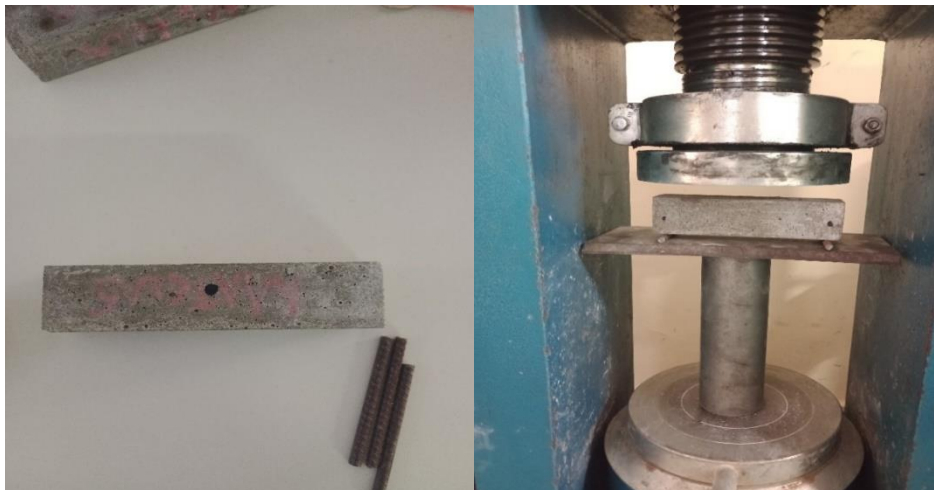
Figura 15 - Corpos de prova, prensa hidráulica e equipamentos adaptados para os ensaios.
