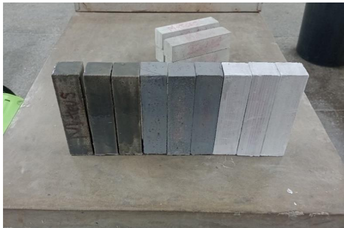
Figura 13 - Corpos de prova secos com produtos impermeabilizantes.
