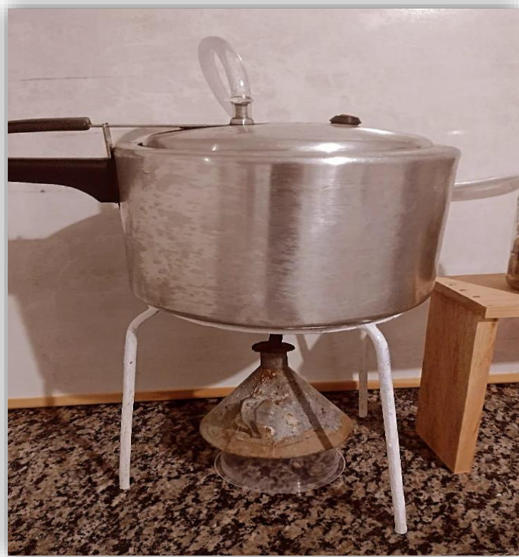
Figura 2- Panela de pressão e fonte de calor candeeiro.
