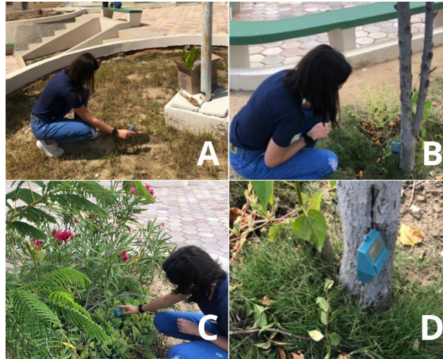
Figura 3 – Aferição de temperatura em solos. A) Sem cobertura; B) Com cobertura (sombra de árvore); C) Com cobertura (arbusto); D) Geotermômetro utilizado nas medições.
