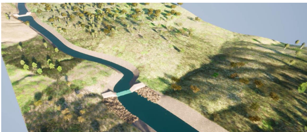
Figura 29 – Locação de soleiras gerada na nuvem de pontos do Matrice.
