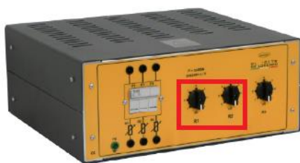
Figura 28: Bancada de carga resistiva.
