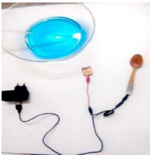
Figura 9: Sistema eletrolítico e colher após a cobreação. Fonte: Própria.
