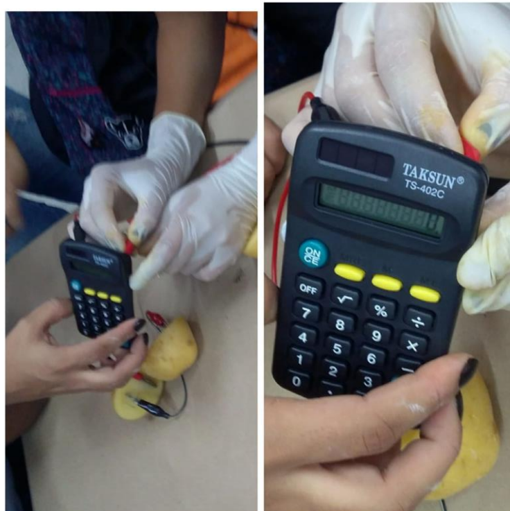
Figura 23: Ligando a pilha de batata na mini calculadora. FONTE: Autoria Própria.
