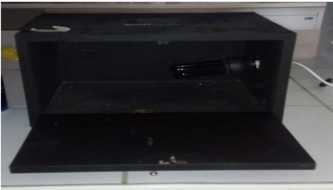
Figura 16: Câmara de raios ultravioleta parte interna
