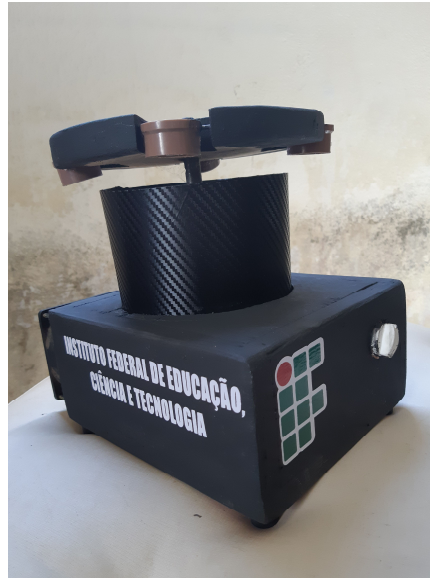
Figura 26. Centrífuga alternativa construída e otimizada
