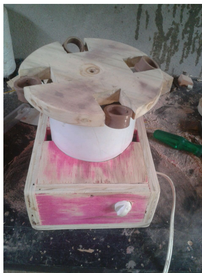
Figura 25. Centrífuga alternativa em construção 2
