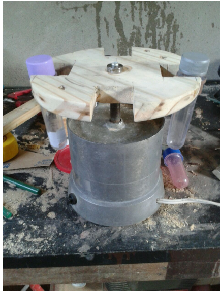
Figura 24. Centrífuga alternativa em construção
