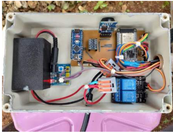
Figura 27 - Circuitos presentes no invólucro principal
