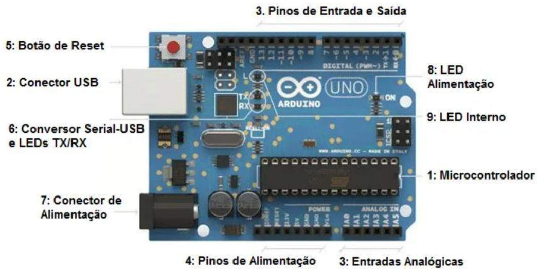
Figura 7 - Placa de desenvolvimento Arduino e seus principais componentes
