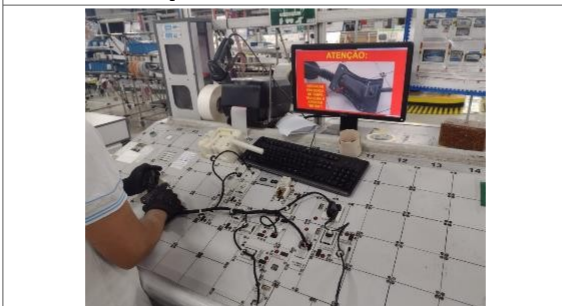
Figura 10 – Processo de teste de continuidade.
