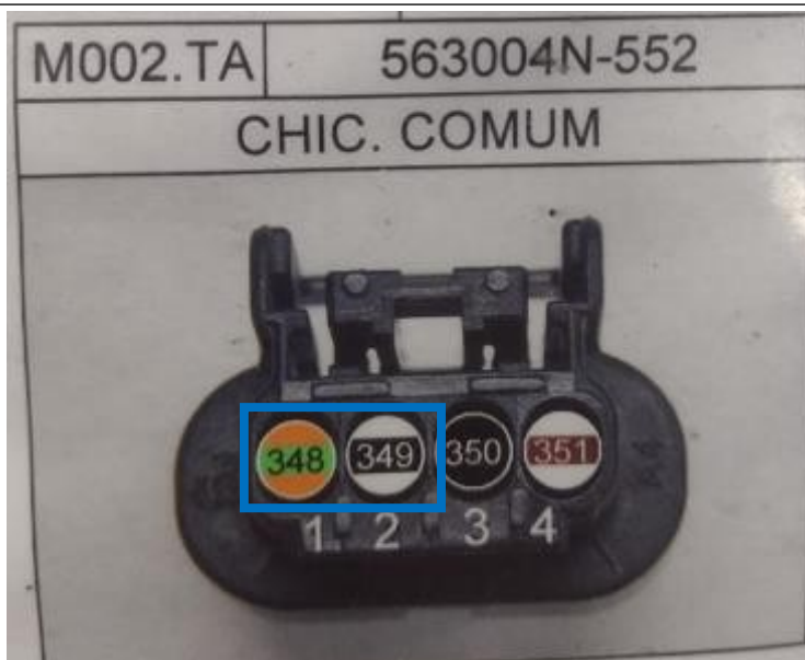
Figura 18– Conector dos circuitos ponto de destino M002.FA
