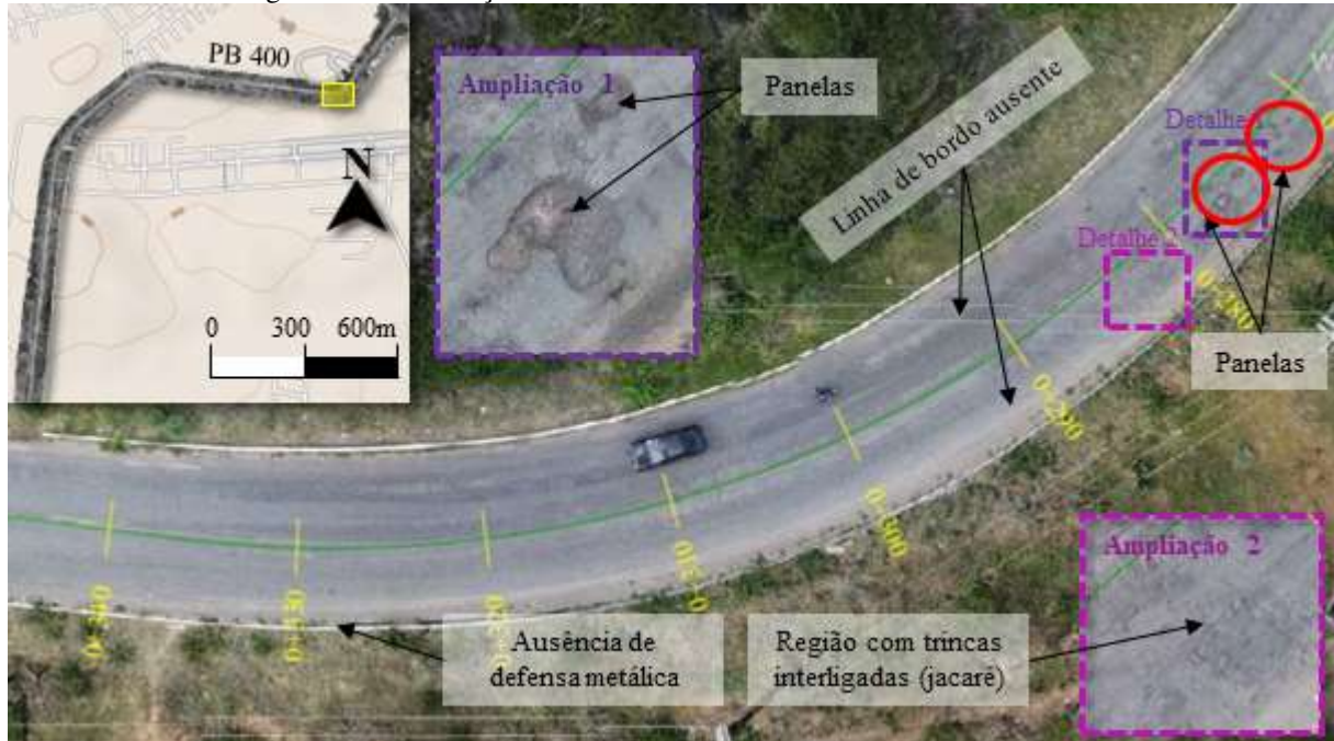
Figura 3 – Identificação dos defeitos da via entre os marcos +270 a +340.
