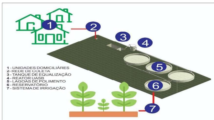
**Figura 2: Esquema de funcionamento do Sistema (Autor)**
