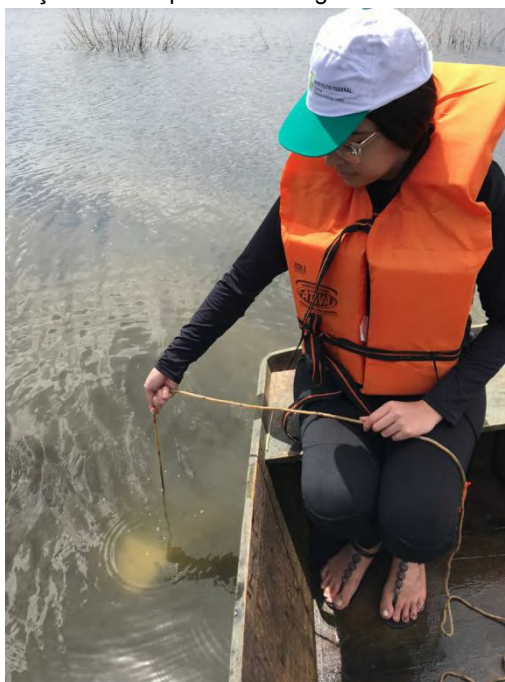
Figura 2 - Medição da transparência da água utilizando Disco de Secchi
