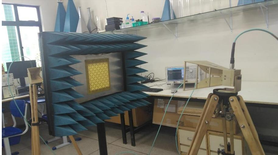
Figura 5.5 – *Setup* de medição para FSS ideal, polarização x, estado *OFF*.
