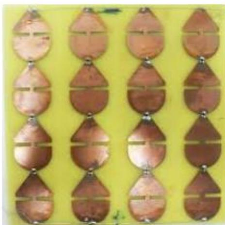
Figura 2.21 – FSS reconfigurável empregada em um absorvedor de radar sintonizável [61].
