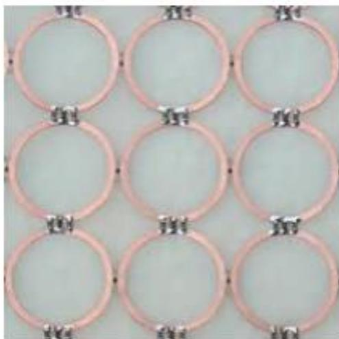
Figura 2.22 – FSS reconfigurável com geometria em forma de anéis de dupla polarização [62].
