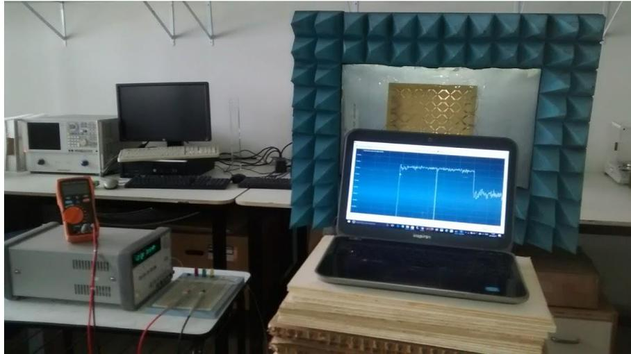
Figura 5.16 – Resposta da intensidade de sinal de Wi-Fi apresentado no *notebook*, polarização y, FSS com diodo PIN.
