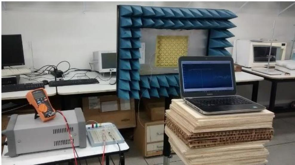
Figura 5.15 – *Setup* de medição da intensidade do sinal de Wi-Fi, polarização y.
