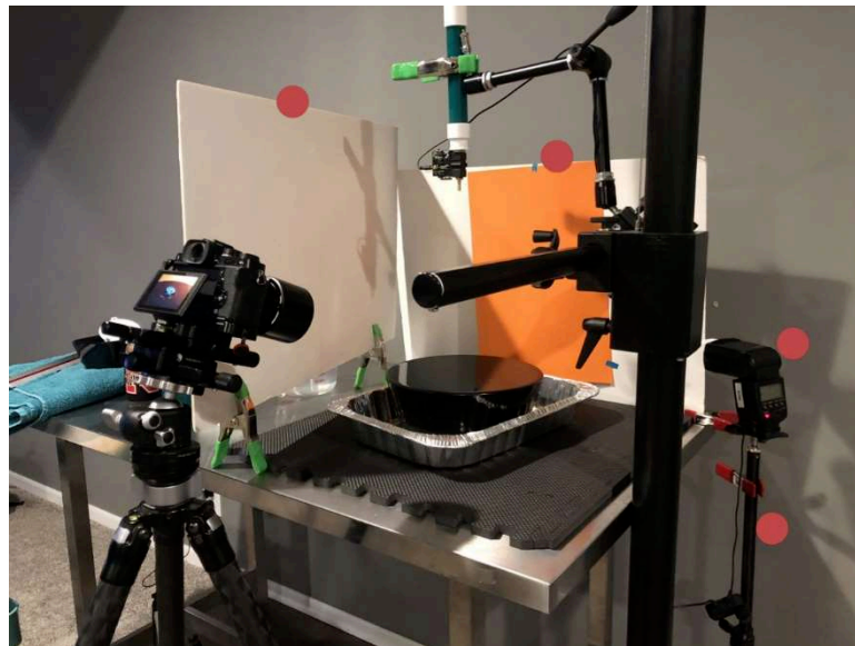
Figura 12 – Estrutura para captura visual de gota em queda
