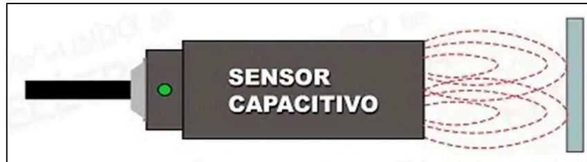
Figura 10 – Funcionamento do Sensor Capacitivo
