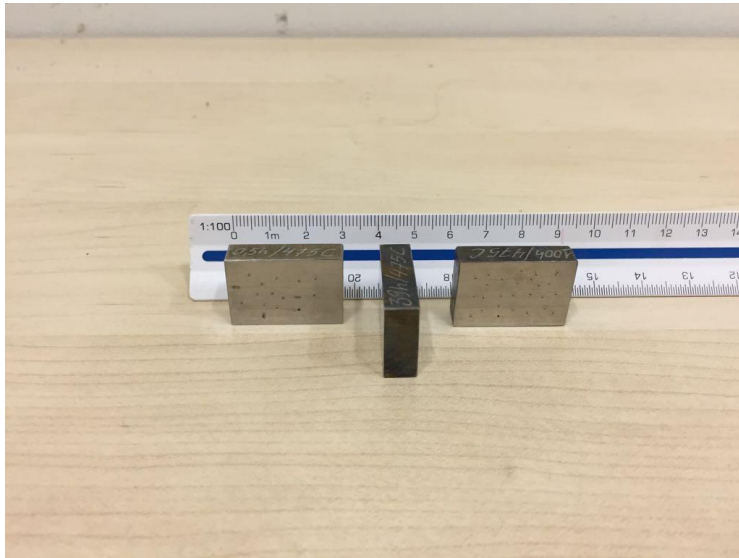
Figura 3.5 - Amostra de aço inoxidável duplex SAF 2205
