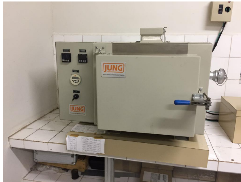
Figura 3.4 – Forno tipo mufla a ser utilizado no envelhecimento das amostras
