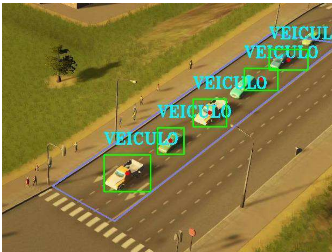
Figura 19: Exemplo de detecção de veículos em um Semáforo.
