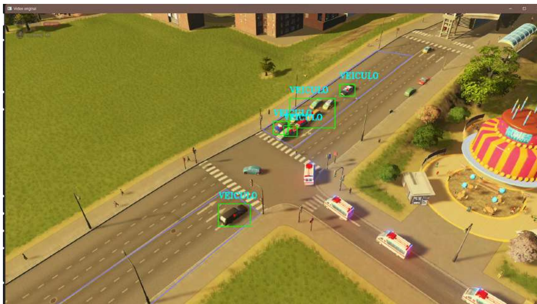
Figura 20: Aplicação do algoritmo de visão em um cruzamento.
