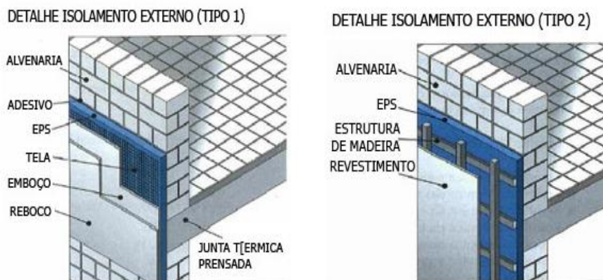
Figura 12 – Isolamento em paredes externas
