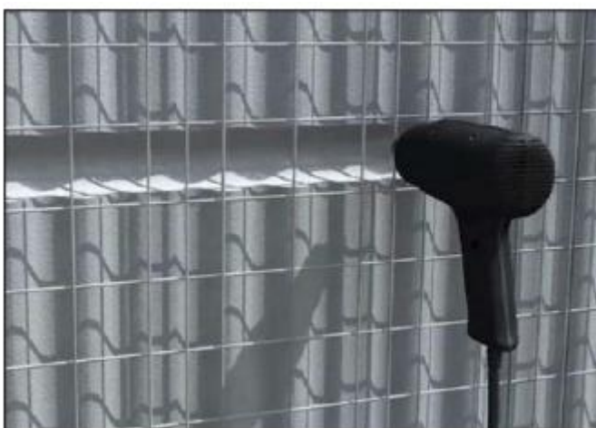
Figura 5 – Abertura de canais com soprador térmico
