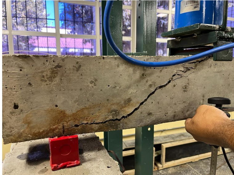
Figura 16 -Fissuras após ruptura por cisalhamento, V3A.
