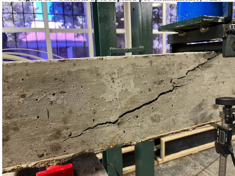
Figura 15 - Fissuras após ruptura por cisalhamento, V2B.
