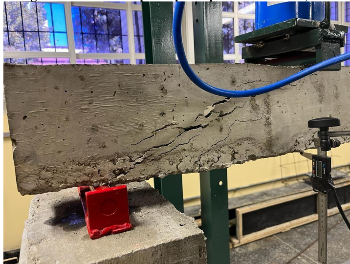
Figura 17 - Fissuras após ruptura por cisalhamento, V3B.
