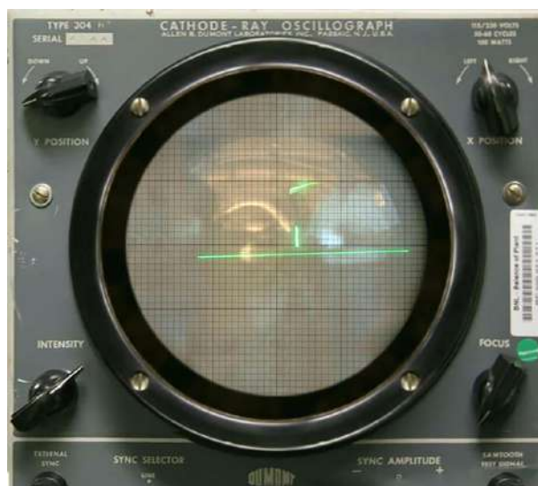
Figura 1 – Tennis for Two em um osciloscópio DuMont Lab tipo 304-A
