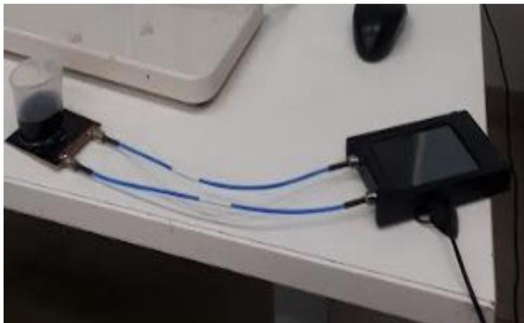
Figura 14 – VNA Lite utilizado para fazer as medições de frequência de ressonância do sensor. Fonte: O Autor.
