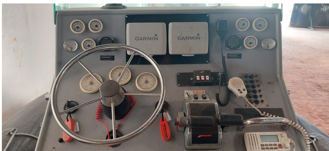
Figura 2 – Painel de instrumentos de uma embarcação tipo Flex Boat SR.
