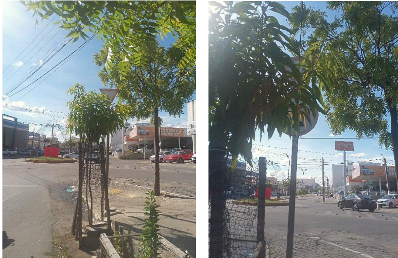
Figura 3 – Sinalização vertical escondida por folhagens no início da avenida.
