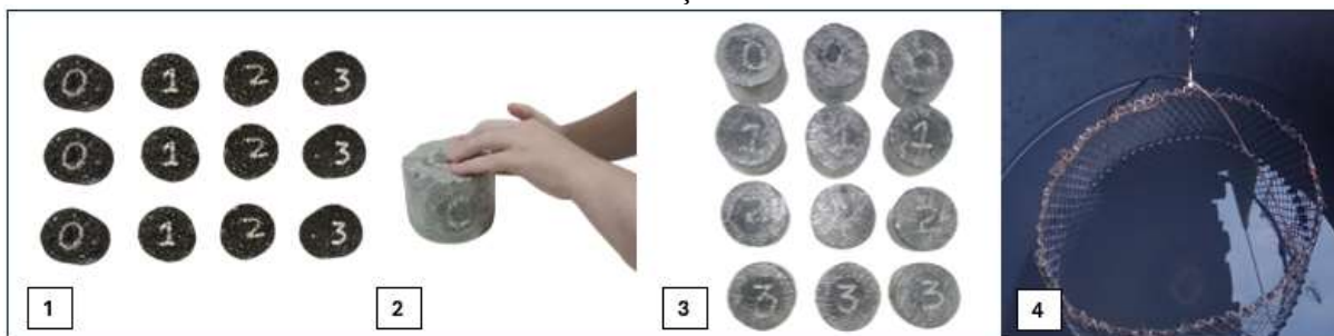
Figura 21 – Determinação da Densidade Aparente – (1) Amostras do Estudo; (2) Pré-Condicionamento das Amostras com Papel-Filme; (3) Amostras Prontas; (4) Pesagem dos Corpos de Prova na Balança Hidrostática
