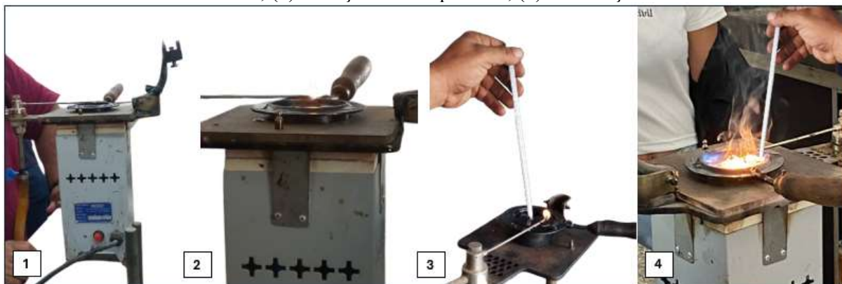
Figura 18 – Ensaio do Ponto de Fulgor – (1) Preparação do Equipamento Caso Aberto Cleveland; (2) Início do Ensaio; (3) Aferição da Temperatura; (4) Finalização do Ensaio
