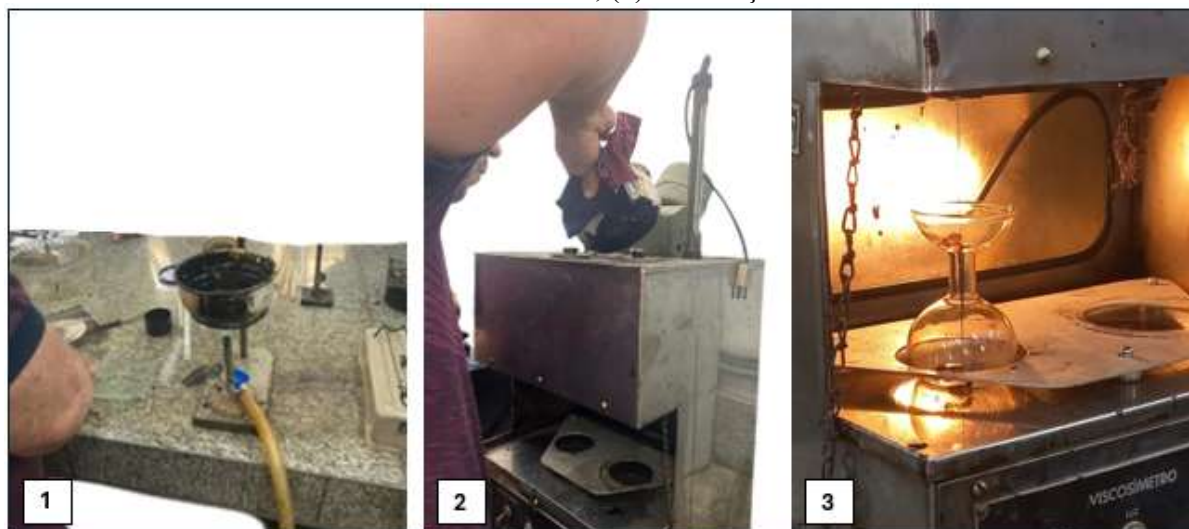
Figura 17 – Ensaio da Viscosidade Saybolt Furol – (1) Preparação da Amostra; (2) Inserção do Material no Viscosímetro; (3) Finalização do Ensaio
