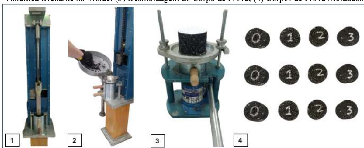
Figura 20 – Moldagem dos Corpos de Prova – (1) Compactador Marshall; (2) Inserção da Mistura Asfáltica Drenante no Molde; (3) Desmoldagem do Corpo de Prova; (4) Corpos de Prova Moldados
