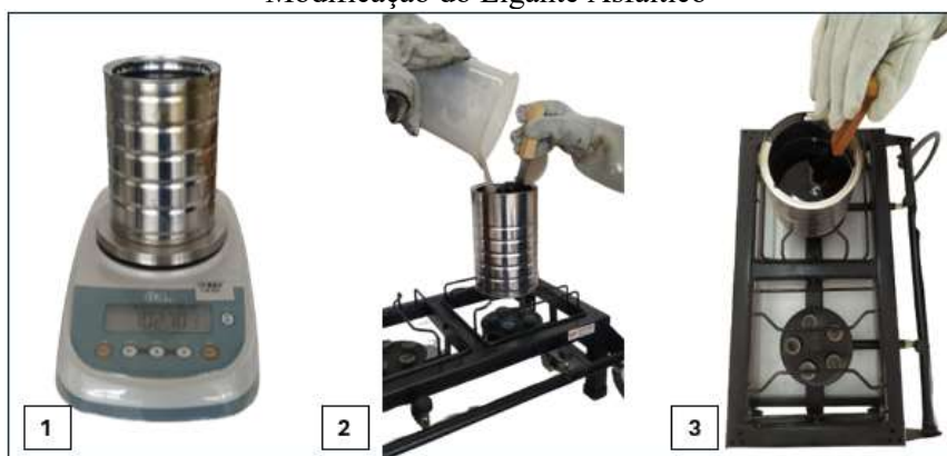
Figura 13 – Modificação do Ligante Asfáltico – (1) Peso em Massa do Ligante Asfáltico para Definição do Quantitativo de Incorporação; (2) Inserção do Resíduo no Ligante Asfáltico; (3) Modificação do Ligante Asfáltico
