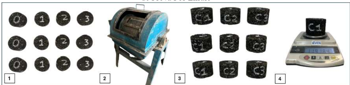
Figura 25 – Ensaio Cantabro – (1) Corpos de Prova Antes do Desgaste Cantabro; (2) Corpo de Prova Dentro do Tambor Los Angeles; (3) Corpos de Prova Pós Ensaio; (4) Pesagem da Massa dos Corpos de Prova Pós Ensaio
