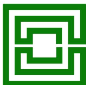
a) Geometria matrioska aberta com três anéis concêntricos
