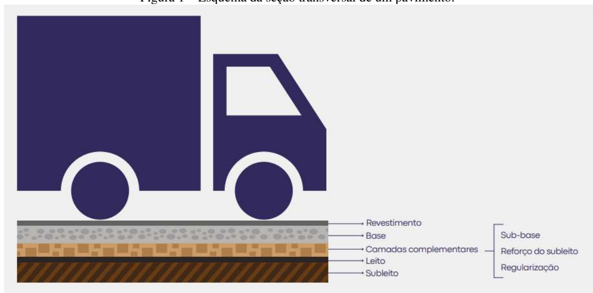
Figura 1 – Esquema da seção transversal de um pavimento.
