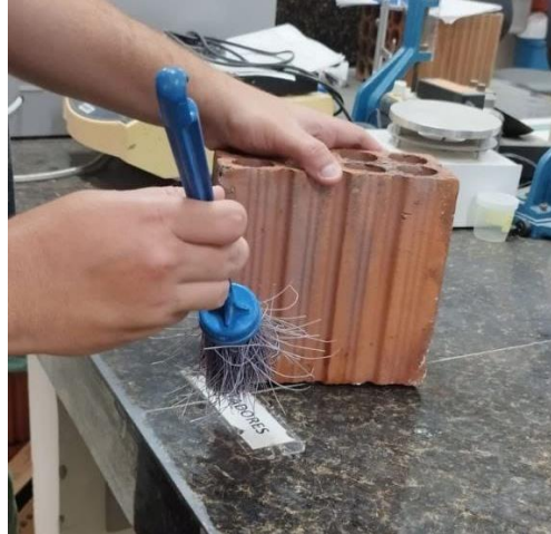
Figura 07- Remoção de sujeitas na superfície do tijolo.
