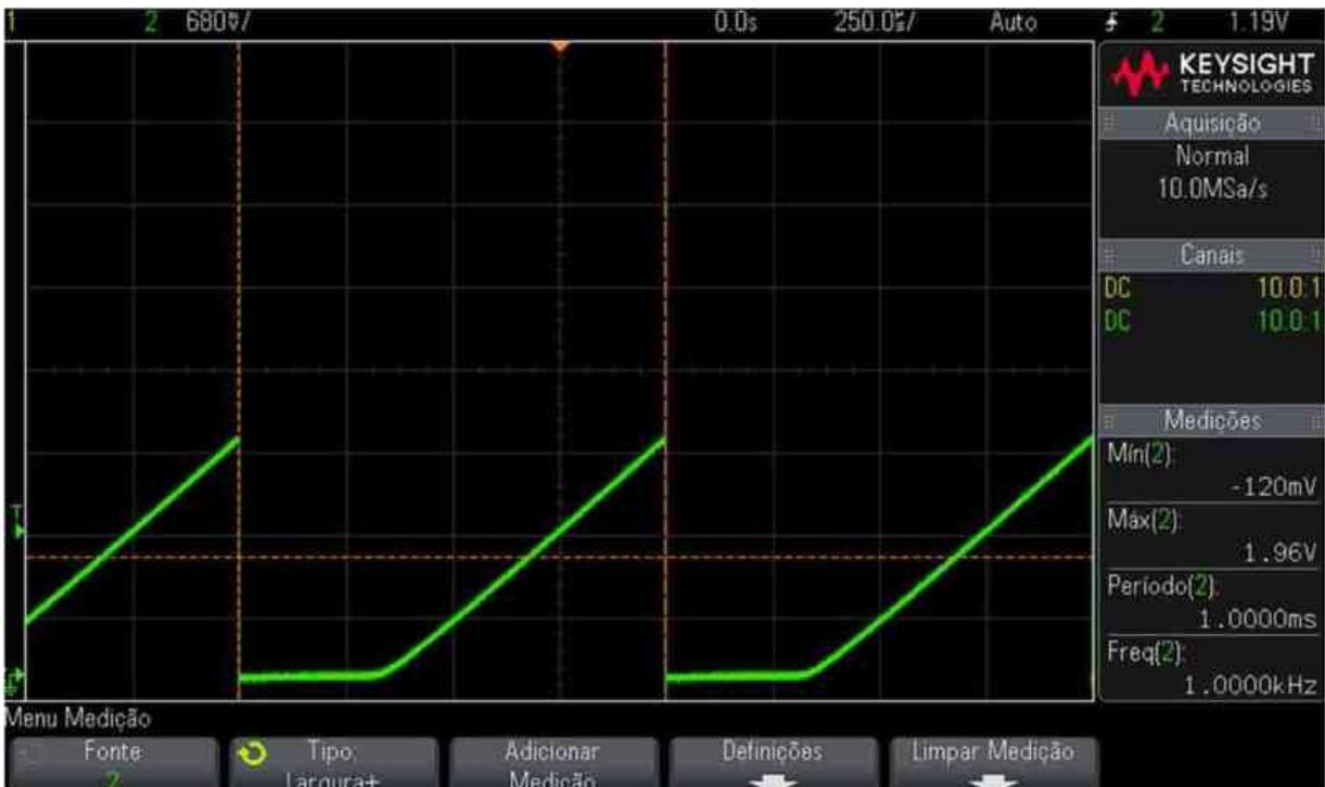
**Figura 46** - Tensão resistor shunt R1 em série com o diodo laser ADL65052TL.
