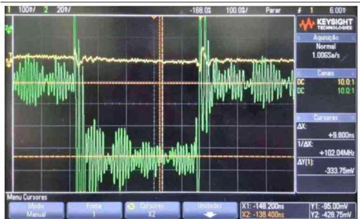
**Figura 60** - Corrente do laser medida através da tensão em um resistor de 10  $\Omega$  em série com o laser.
