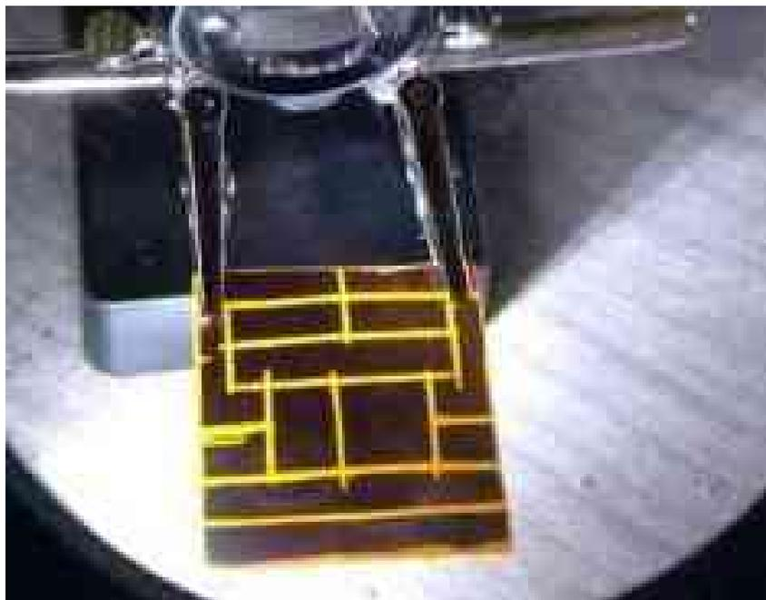
**Figura 58** - Placa desenhada e construída manualmente com auxílio de uma micro retífica.
