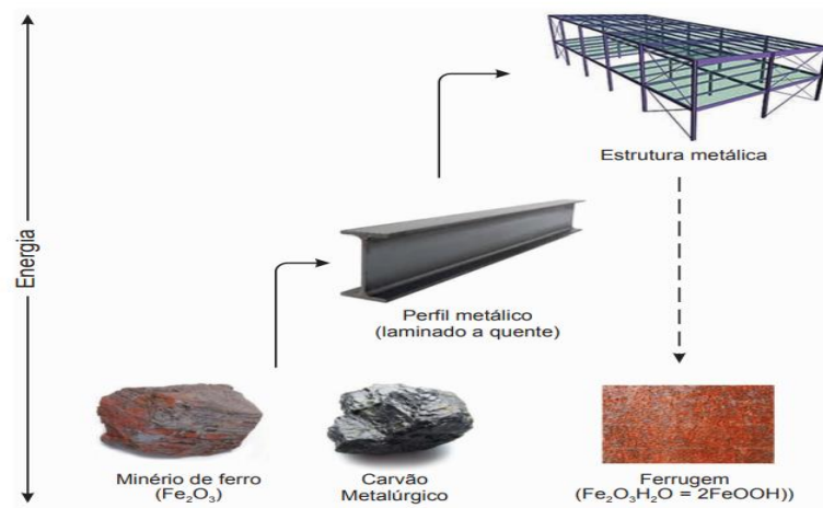
Figura 5 - Processo de corrosão do aço.
