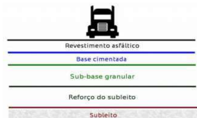
Figura 5 – Estrutura do pavimento semirrígido
