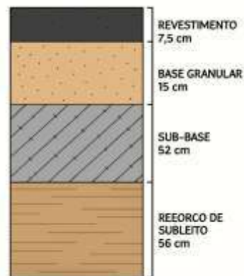
Figura 31 – Camadas dimensionadas
