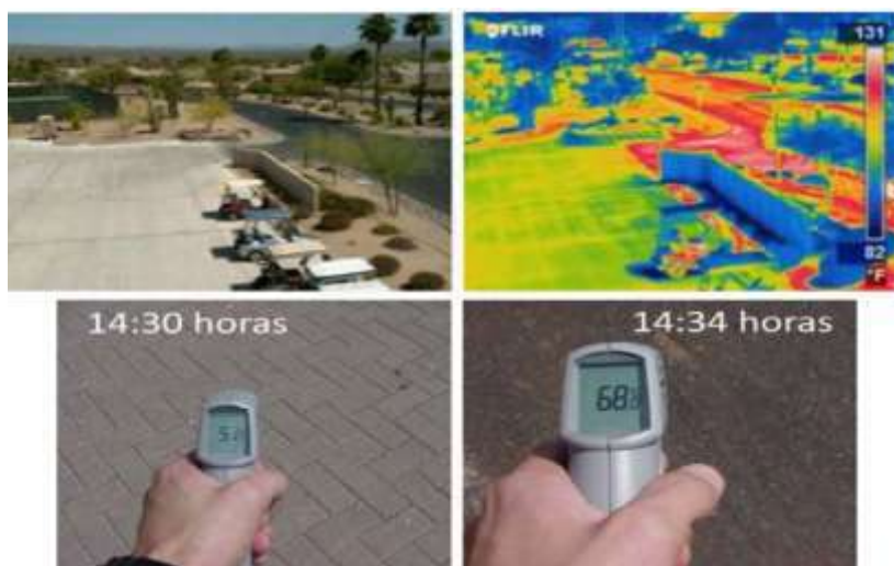
Figura 7 – Comparação de temperatura em superfícies
