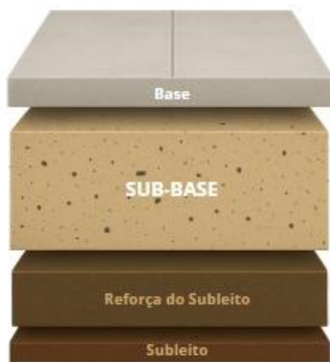
Figura 3: Representação ilustrada das camadas do revestimento de CBUQ.
