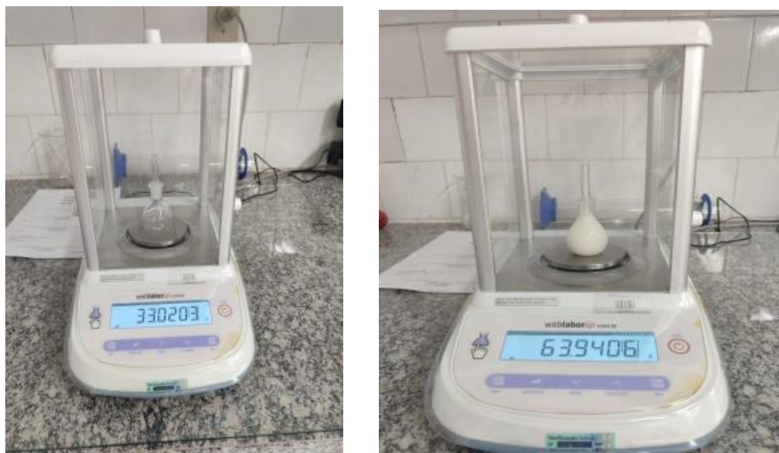
Figura 3 - Picnômetro sendo pesado em balança analítica
