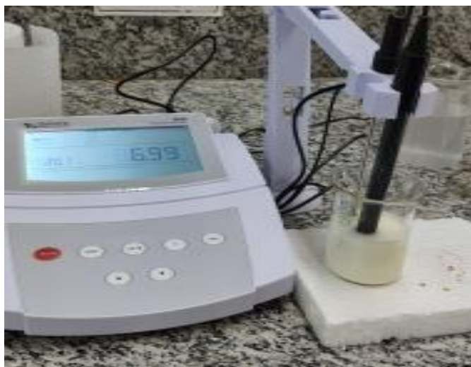
Figura 1 - Medição do pH do leite utilizando pHmetro digital.
