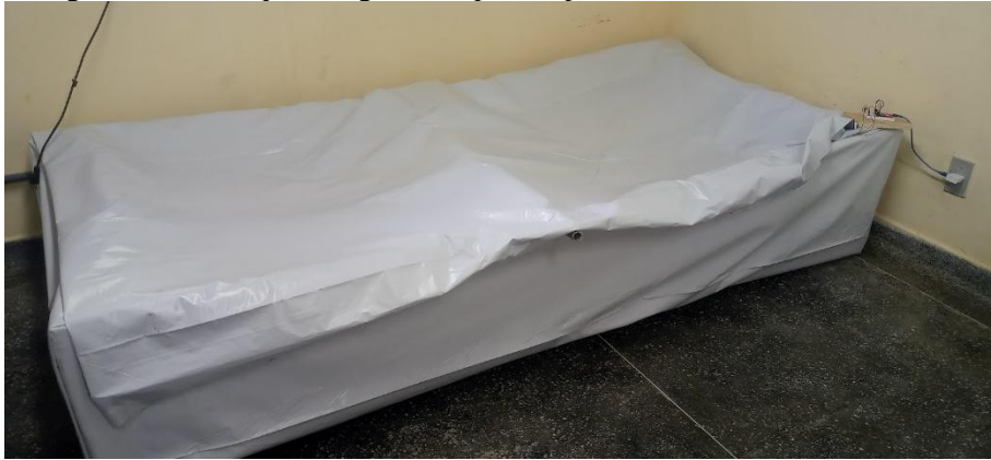
Figura 4: Estufa que abriga os corpos de prova em ambiente controlado.
